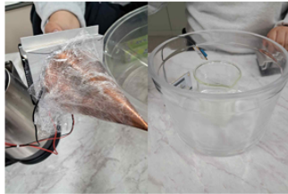
<그림 9> 뿔티어 소자 냉각기와 구리관을 합친 모습, 원형 수조와 내부 비커의 모습
