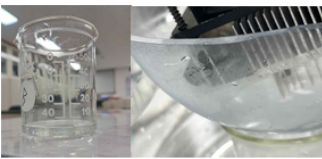
<그림 16> 플라스틱 반구를 활용하였을 때의 응결량(약 5ml)과 플라스틱 반구 광표면에 물이 응결된 모습
