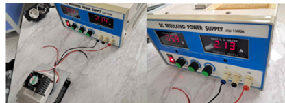
<그림 5> 전원 공급 장치를 활용하여 펄티어 소자 냉각기에 전력을 공급해주는 모습
