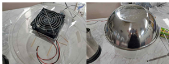
<그림 14> 플라스틱 반구를 활용한 측정 방법을 준비한 모습과 스타인리스 볼을 활용하여 수조 내부의 온도를 유지시켜 주고 있는 모습
