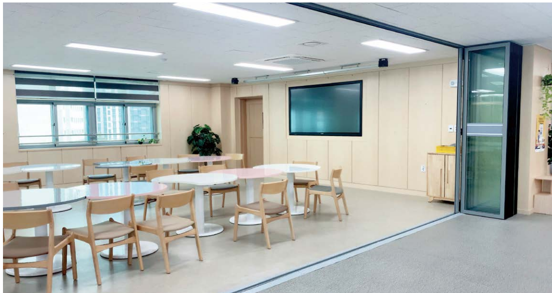
수업공간 앞에는 86inch 전자칠판을 설치하여 발표 수업 또는 세미나, 창체활동 등을 진행할 수 있는 기반을 마련하였으며, 폴딩도어를 설치하여 도서관 내부의 공간분리를 하였음.
